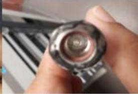
conector mal armado
